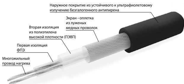
Конструкция кабеля нагревательного мата ELEKTRA SnowTec ® Tuff
