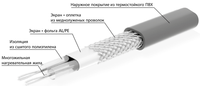
Конструкция нагревательного мата ELEKTRA SnowTec®
